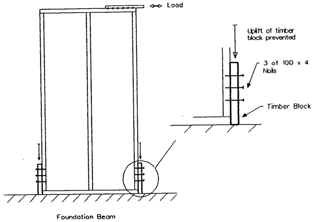
FIGURE 1 TYPICAL P21 TEST
